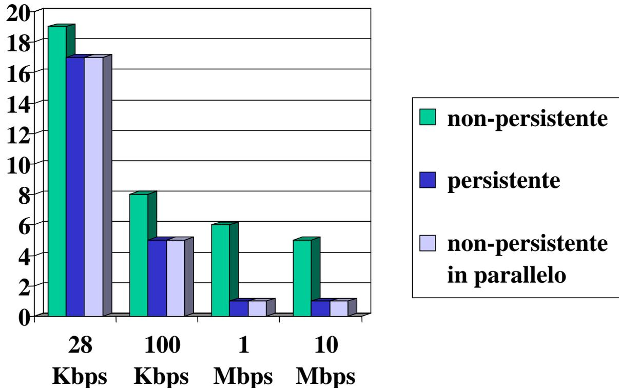
Se l'ampiezza di banda è limitata, la connessione e il tempo di risposta sono dominati dal tempo di trasmissione.
